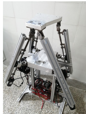
图2 并联机构实物样机
